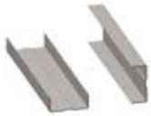
La canaleta de carga es un perfil rolado en frío y fabricado con acero galvanizado. Está fabricada en calibre 22 y está hecha para trabajar en conjunto con el canal listón y soportar los falsos plafones.
