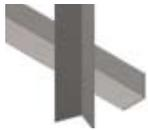
El ángulo metálico o ángulo de amarre es un perfil rolado en frío y fabricado con acero galvanizado. Está fabricado en calibre 20. Su función es la de asegurar muros, lambrines y plafones, además de servir como refuerzo en bastidores para muros divisorios con placa de yeso y cemento.
